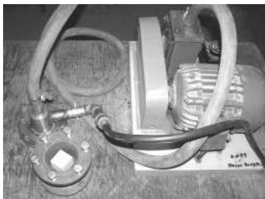
Рис. 1 – Камера для вакуумирования и последующего насыщения флюидом горных пород
