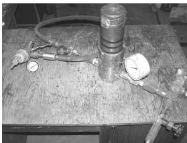
Рис. 2 – Стенд-камера для нагружения газо-водонасыщенных образцов под прессом
